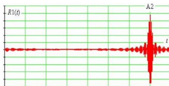
Рис. 2 Сигнал на выходе ЛЧМ-Ф1 R1(t) , при приеме согласованного сигнала s1(t) с возрастающей ЛЧМ
