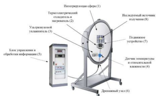
Рис. 2 Общий вид устройства для измерения характеристик светодиодных источников света
