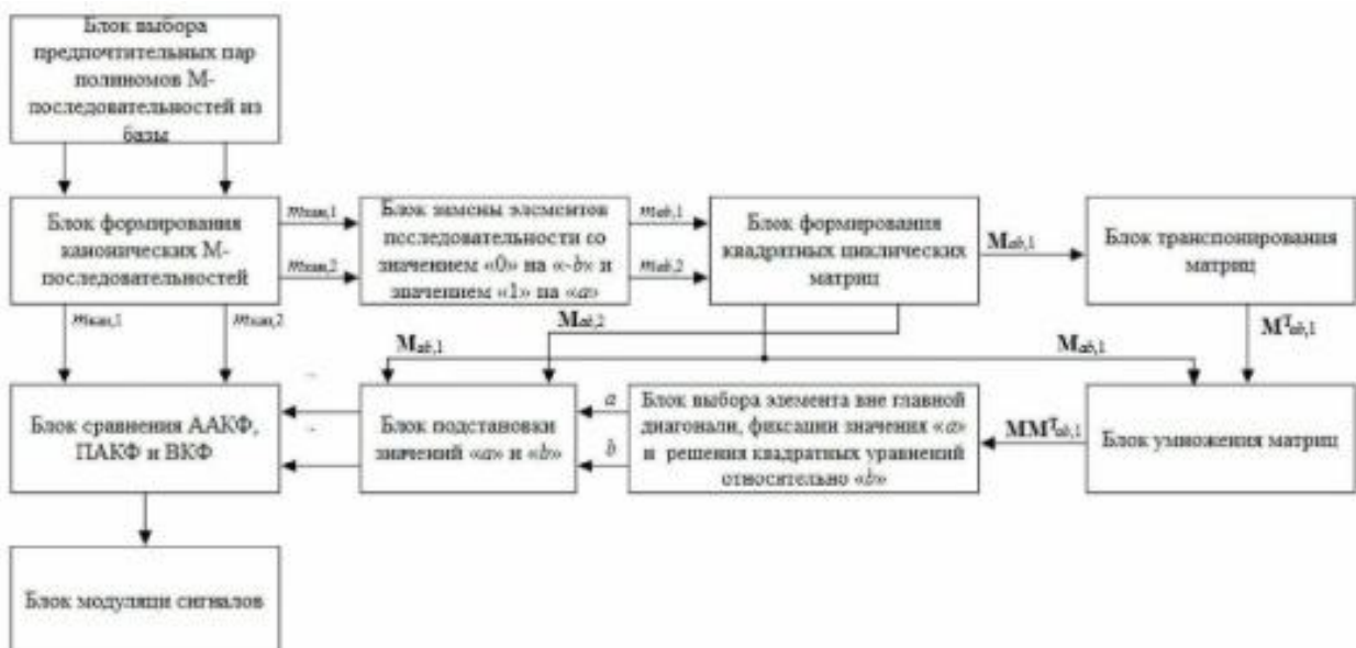
Рис.1 – Структурная схема способа формирования квазиортогональных кодовых последовательностей
