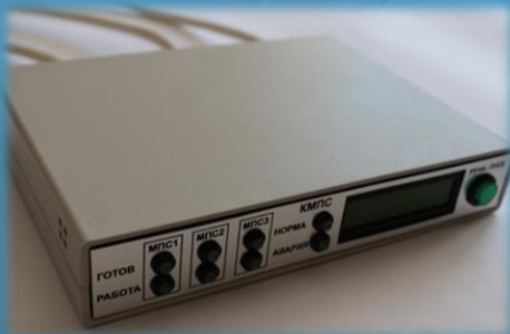
1) Коммутатор питания сетевых модулей
