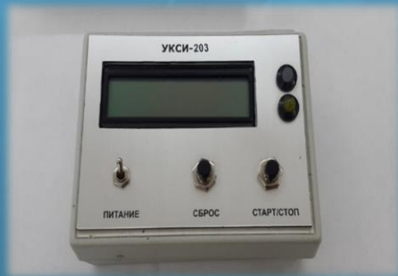
7) Устройство контроля сопротивления изоляции ТСС (УКСИ-203)
