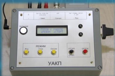
2) Устройство автоматизированного контроля параметров
