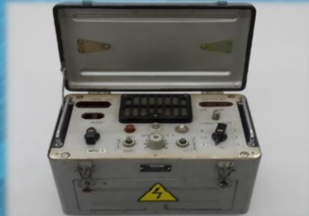
9) Имитатор помех в сети электропитания (ИПС-1)
